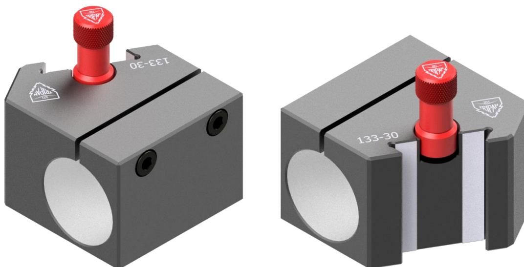
Der **Stangenhalter Tripan® 133-30** ermöglicht dank seiner hohen Steifigkeit eine hervorragende Bearbeitungsqualität. Seine hervorragende Wiederholgenauigkeit sorgt für präzises Arbeiten bei häufigen Werkzeughalterwechseln. Seine Haltbarkeit ist bewährt. Der Stangenhalter Tripan® 133-30 wird auf Tripan® Spanneinheiten der **Serien 1 und 2** montiert. Er hat eine Öffnung von  $\varnothing 30$  mm zur Aufnahme einer Stange oder verschiedener Tripan®-Hülsen.
